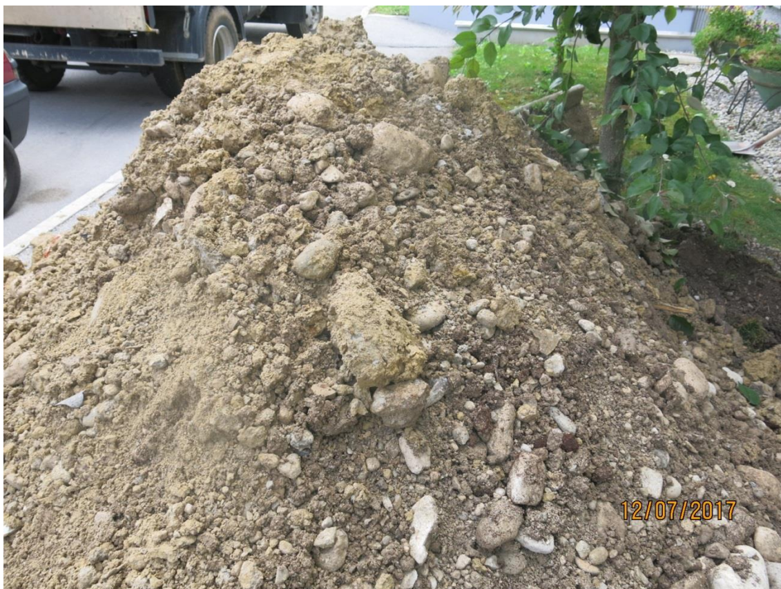
Slika 51: Izkopani material iz sondažnega izkopa - peščeni grušč in kosi sivorjavega melja v težkognetni konsistenci z dna izkopa
