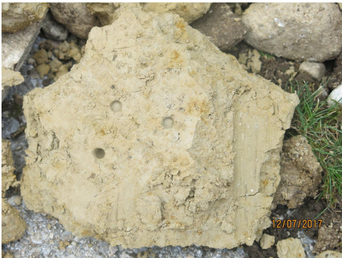
Slika 52: Preskus z ročnim penetrometrom
